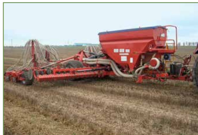
Рисунок 6 – Сеялка прямого посева СПП-9
