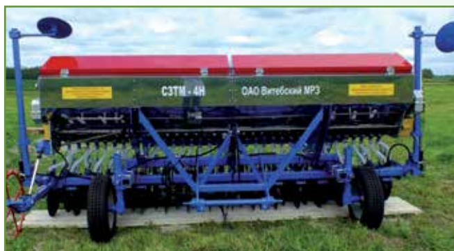
Рисунок 5 – Сеялка зернотуковая механическая навесная СЗТМ-4Н
