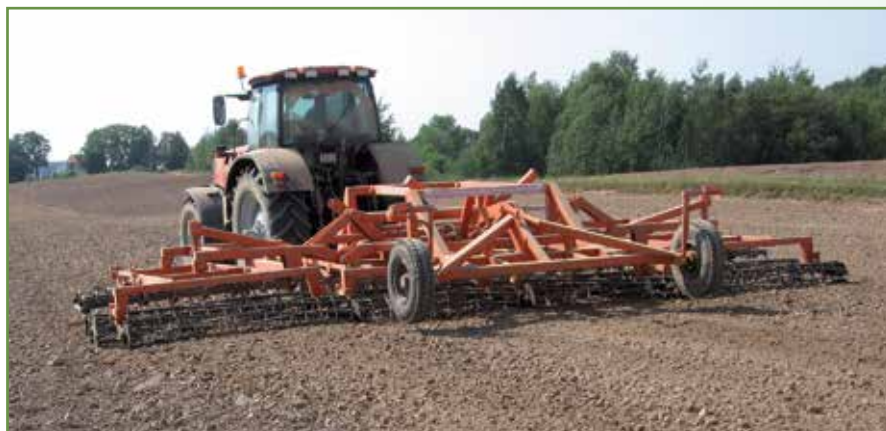
Агрегат для предпосевной обработки почвы АКШ-9
