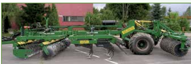
Рисунок 3 – Агрегат почвообрабатывающий многофункциональный АПМ-6
