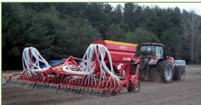
Рисунок 4 – Сеялка пневматическая С-9
