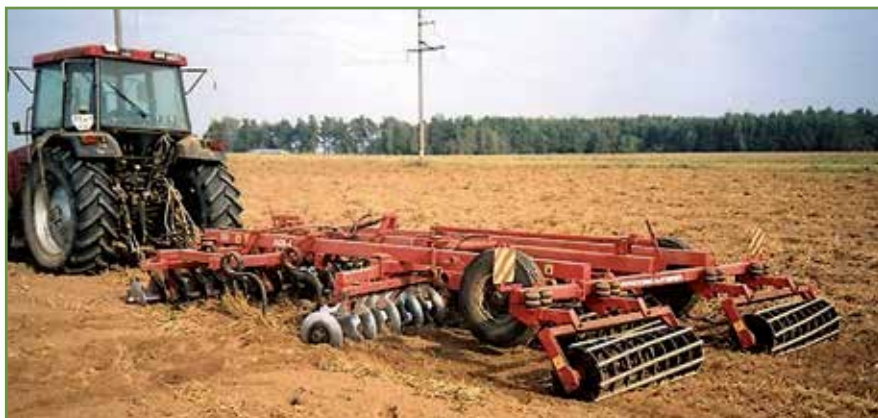
Рисунок 2 – Агрегат для минимальной обработки почвы АКМ-4
