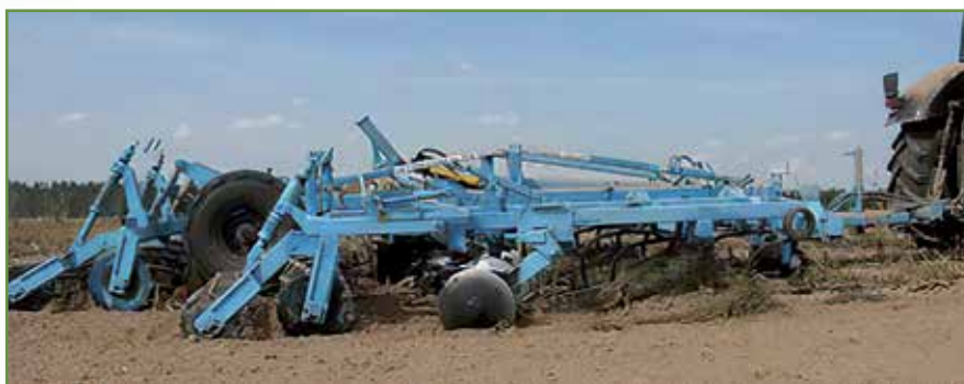
Рисунок 1 – Культиватор чизельно-дисковый КЧД-6
