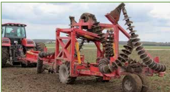
Рисунок 1 – Луцильник дисковый ромбовидный ЛДР-9
