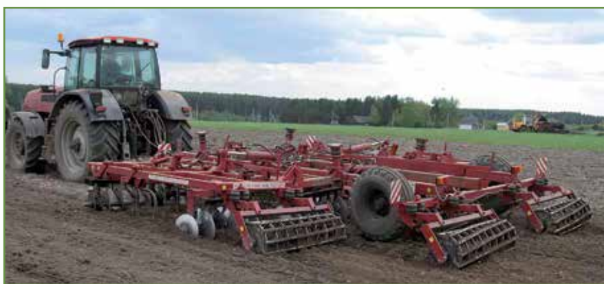
Рисунок 3 – Агрегат для минимальной обработки почвы АКМ-6
