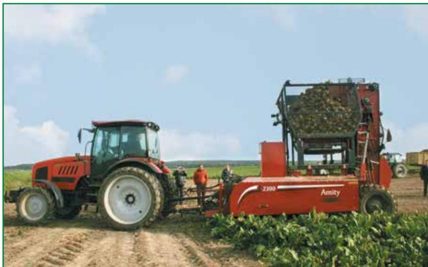
Рисунок 2 – Прицепной комбайн Amity
