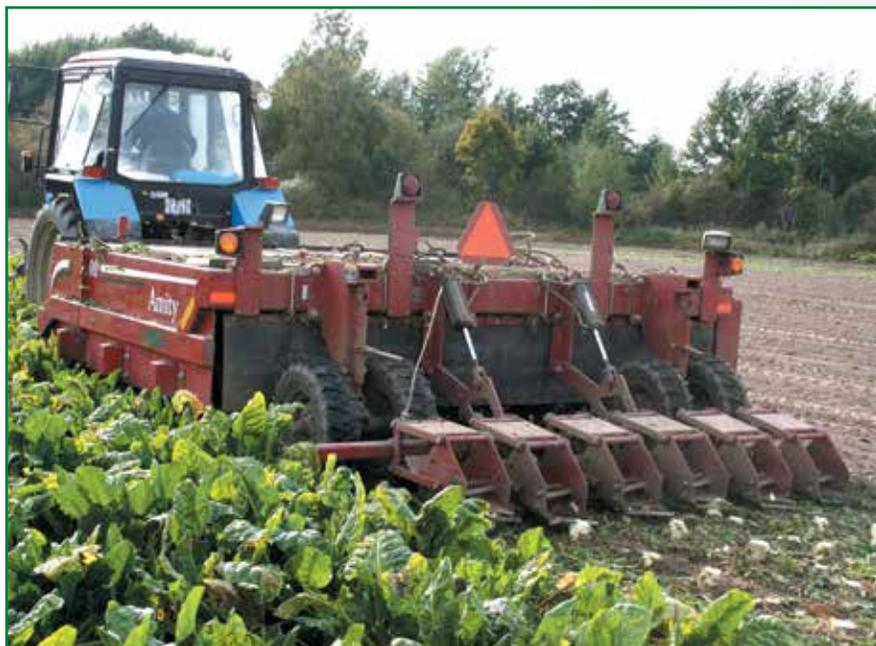
Рисунок 1 – Работа дефолиатора (ботвоудалителя)
