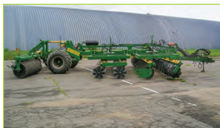
Рисунок 4 – Агрегат АПМ-6 в комплектации сменных рабочих органов для обработки почвы на глубину 6–12 см
