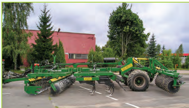
Рисунок 6 – Агрегат АПМ-6 с комплектом сменных рабочих органов для обработки почвы на глубину 12–25 см
