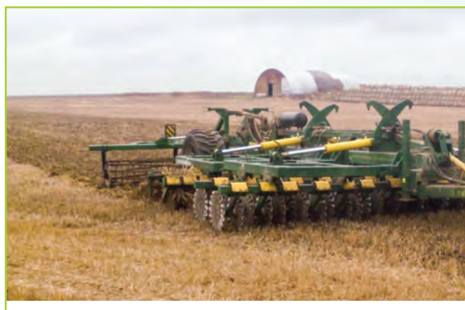
Рисунок 11 – Агрегат АПМ-6А на послеуборочной мульчирующей обработке стерневого агрофона
