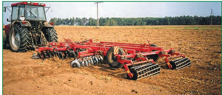
**Рисунок 3 – Агрегат для минимальной обработки почвы АКМ-4**
