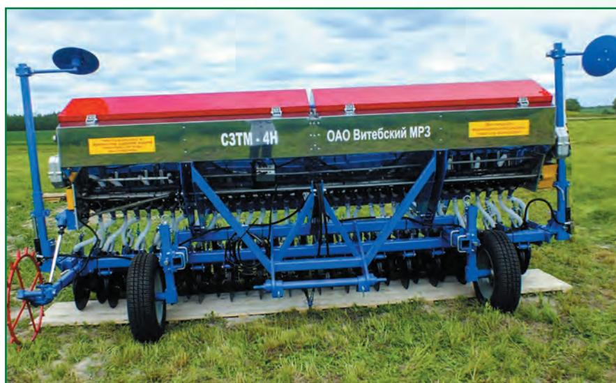
Рисунок 4 – Сеялка зернотуковая механическая навесная СЗТМ-4Н
