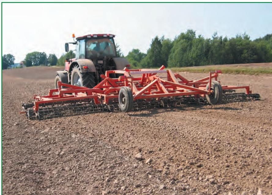
Агрегат для предпосевной обработки почвы АКШ-9
