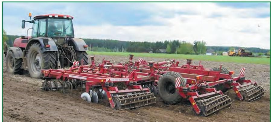
**Рисунок 4 – Агрегат для минимальной обработки почвы АКМ-6**
