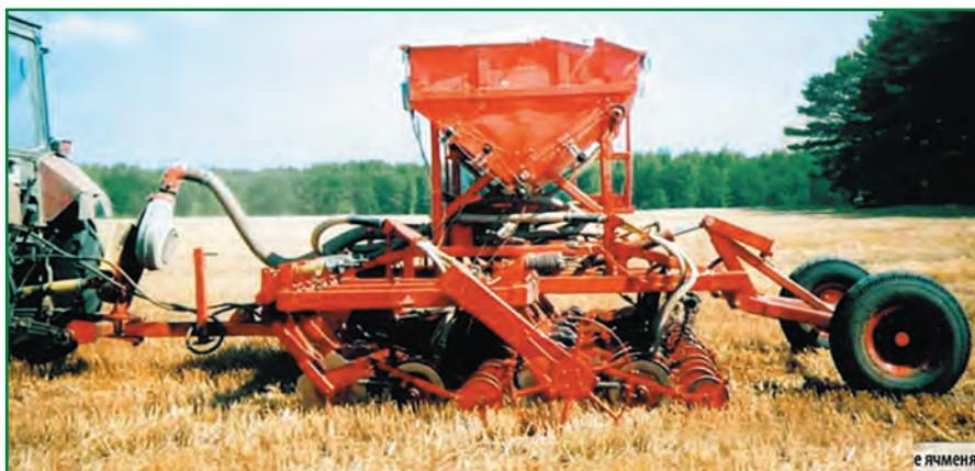
Рисунок 5 – Сеялка прямого посева СПП-3,6
