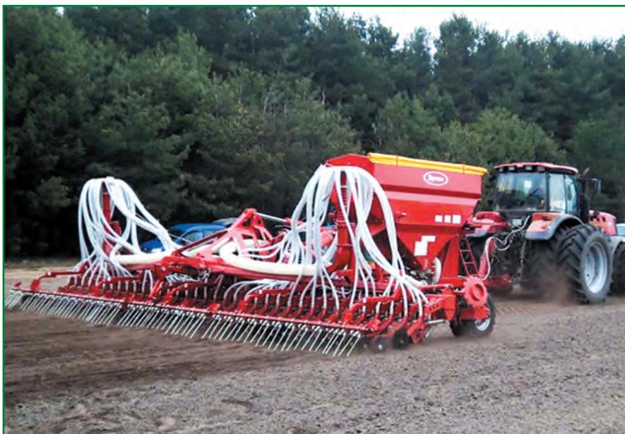
Рисунок 3 – Сеялка пневматическая С-9
