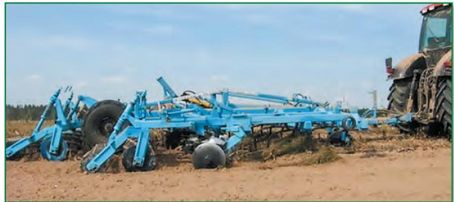
**Рисунок 2 – Культиватор чизельно-дисковый КЧД-6**
