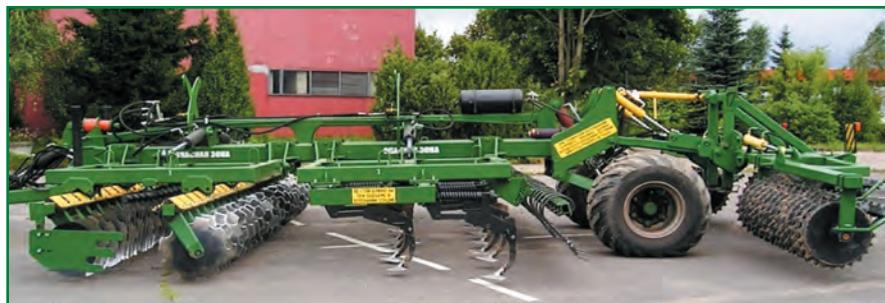
Рисунок 2 – Агрегат почвообрабатывающий многофункциональный АПМ-6
