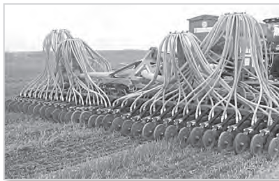
Рисунок 5 – Сеялка прямого посева СПП-9
