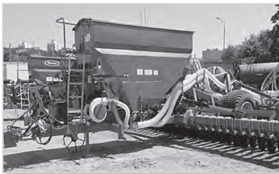
Рисунок 5 – Сеялка прямого посева СПП-9
